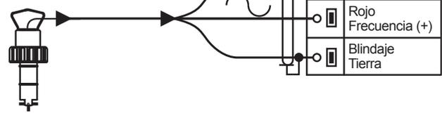
Conexiones del sensor 2536 a instrumentos Signet
