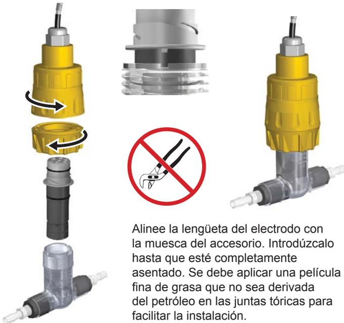
No ponga lubricante ni cinta adhesiva de sellado en las roscas. No apriete excesivamente. No apriete con herramientas.
