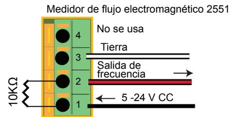
Instale una resistencia de activación cuando conecte el medidor de flujo electromagnético 2551 a los medidores de flujo de otros fabricantes.
