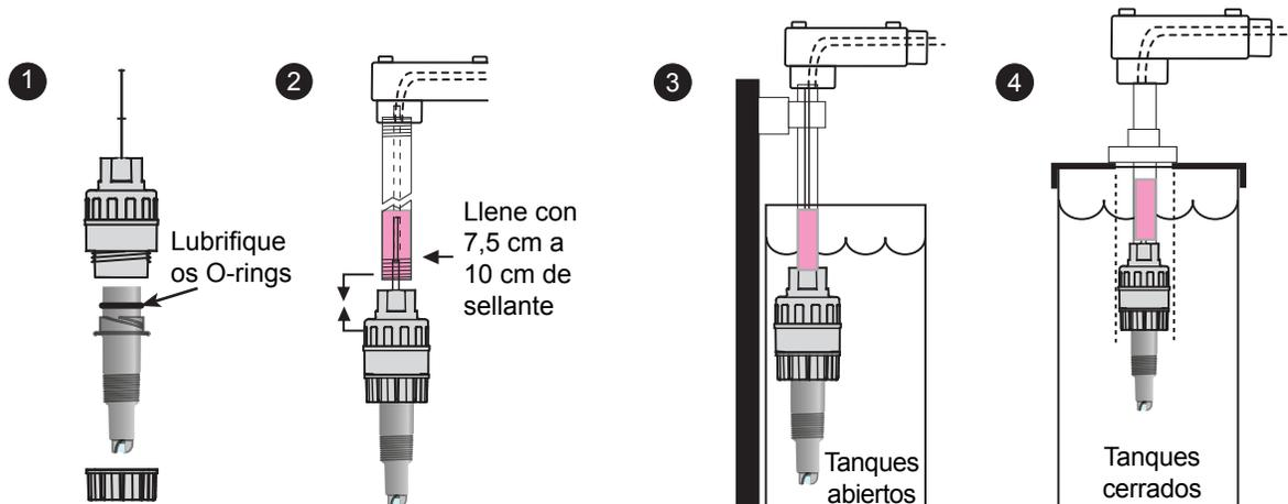
Los electrodos de pH/ORP de Signet están diseñados para instalar en tanques conectando conductos a las roscas de ¾ pulg (ISO 7/1 R de ¾ pulg.) de la parte superior del preamplificador auxiliar o componentes electrónicos del sensor
