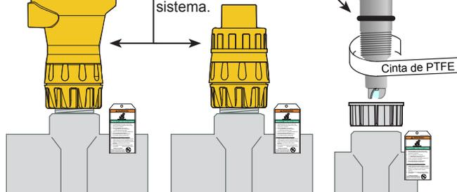
Conexiones de instalación
